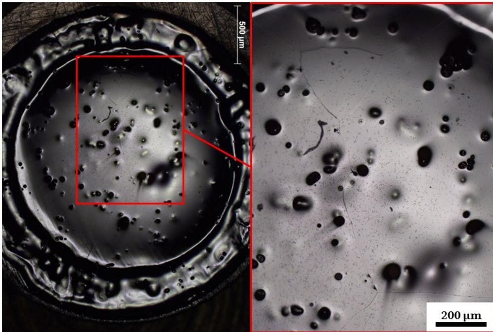
Abbildung 41: lichtmikroskopische Aufnahmen einer TEM-Scheibe nach 3 h Ionenstrahlpolitur. Die Linien entsprechen dem Verlauf von Korngrenzen.
